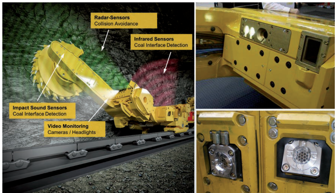
Bild 4: Umfelderfassungssysteme am Walzenlader
