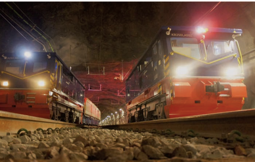
Bild 10: Beispiel des vollautomatischen Schalte-Zugfördersystems bei LKAB
